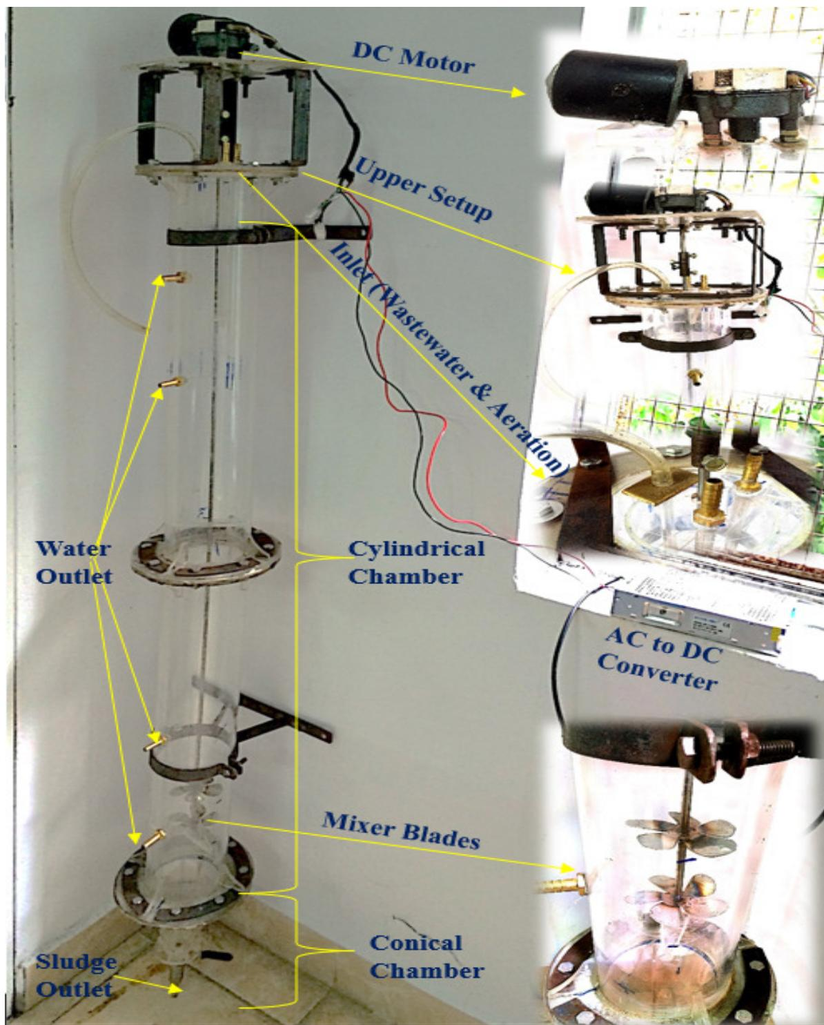
Fig.-1: Reactor Setup
